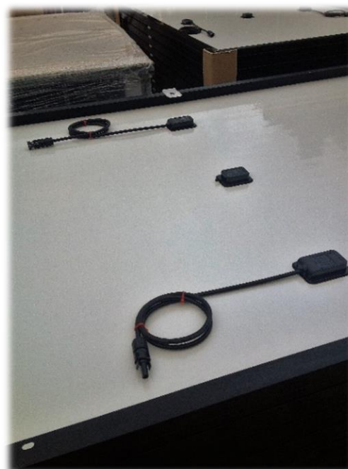
Figuur 3 De traditionele junction box is in 3-delen gesplitst, daardoor ontstaat minder warmte in het paneel en dus minder verlies van opgewekte stroom.
